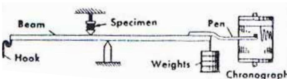
FIGURE 2 YERZLEY OSCILLOGRAPH
